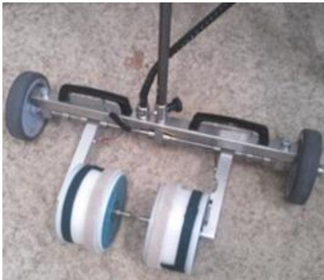
*Electrodes à roues (mesure potentiel)*
