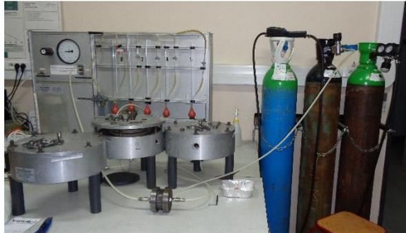
Mesure de perméabilité au gaz
